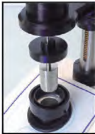
溶剂阱系统可以在样品使用液体密封方式时保证溶剂不会挥发或干燥
