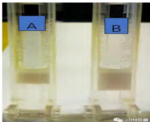
**第一步：**60 分钟以后，实验结束，取出样品 A 和 B，用肉眼观察 A, B 两个样品，可以发现样品 A 上浮的程度大于样品 B，初步可得样品 A 相对样品 B 是较不稳定的。
