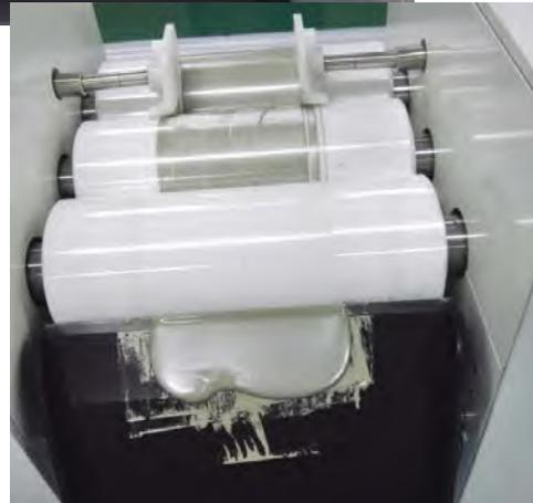
分散研磨工艺如下：（间隙模式）
