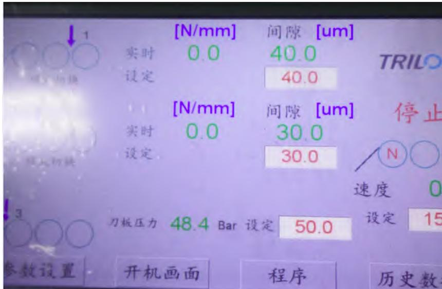
在间隙模式下连续进行两个循环的预混合后，浆料流动性会有所改善。因此可以确定浆料已经通过间隙间的剪切力被充分混合了。此时浆料的细度如下图所示，大于 8um，可见在预混合的过程中，已经出现部分分散效果。但要达成最终细度，还需要采用 TR80A 的压力模式来进行进一步研磨。
