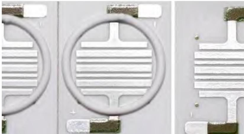
一般来说，用于陶瓷金属化的钨浆粘度较高，基本上都在 80000Cps 以上；而要求的细度则在 4 $\mu$ m-5 $\mu$ m。由于普通三辊机能够最终达成的分散研磨细度都在 10 $\mu$ m 以上，所以需要采用高精度的三辊机来进行分散研磨。以下例应用案例来说，我们就采用了 TRILOS 公司的 TR80A 型三辊机对粘度为 85000Cps（采用 TRILOS 的 RH-x 型流变测得）进行分散处理。
