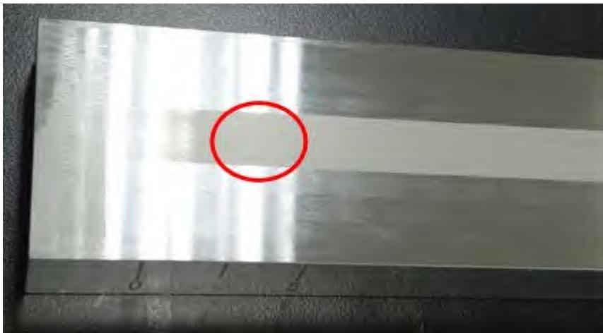
结束后，使用刮板细度计对银浆进行测试，细度读数为 3.5um，有效的提高了正银浆料的分散细度以及均匀性。
